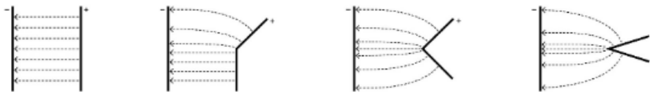
Abbildung 3: Elektrische Felder zu den Metallplatten-Anordnungen der Abbildung 2.
